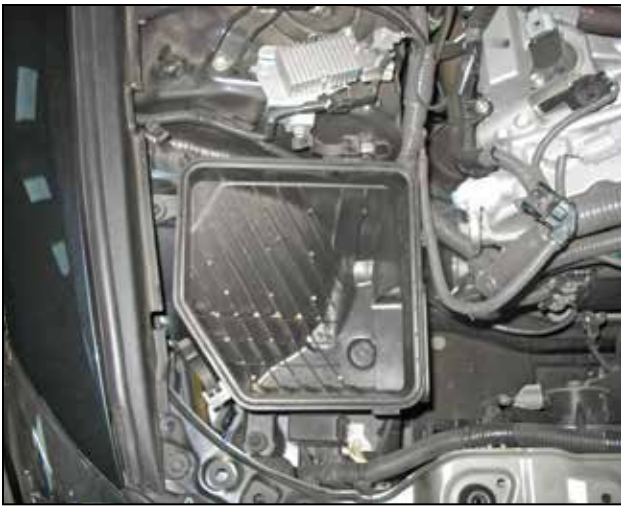
k. Remove the air filter.
